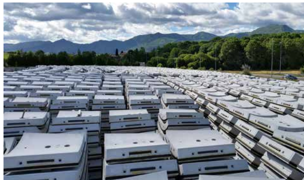
Túnel Santona Laredo: BarChip redujo la huella de carbono en un 77% respecto al diseño original de acero.
